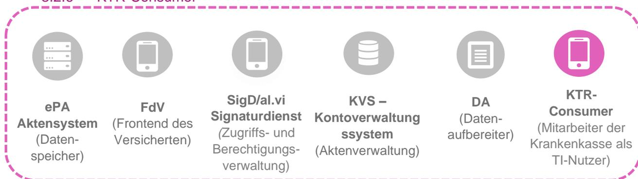
Der KTR-Consumer ermöglicht es, Mitarbeitern der gesetzlichen Krankenkassen als Nutzer an der TI teilzunehmen. Genutzt werden können dabei Fachanwendungen (Unterstützung von sicheren Übermittlungsverfahren (KIM) und ePA (Einstellen von Sozialdaten durch die gesetzliche Krankenkasse in die ePA über ein ePA-Fachmodul)), bei denen die Krankenkassen als berechtigte Nutzer festgelegt sind.
